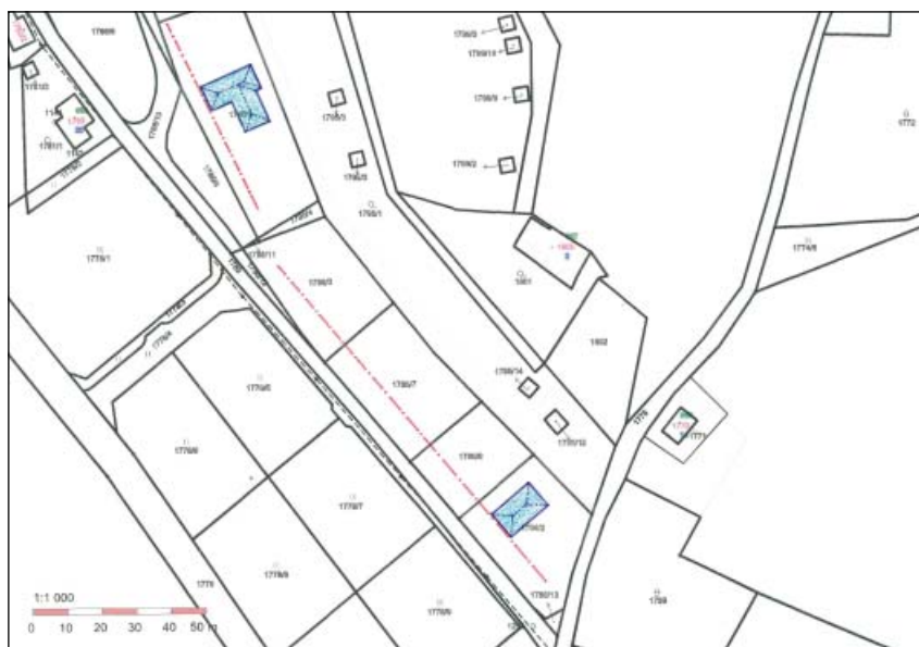
Obr. 5: Zákres půdorysů obou rodinných domů a jejich osazení směrem ke stavební čáře
