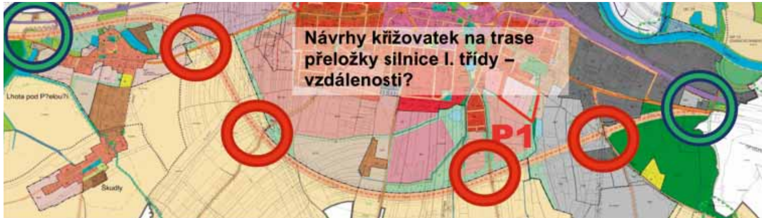
Obr. 6 Návrh šesti křižovatek na přeložce silnice I. třídy (obchvatu města) – zeleně jsou označeny křižovatky, kde se trasa obchvatu musí odpojit ze stávající trasy
