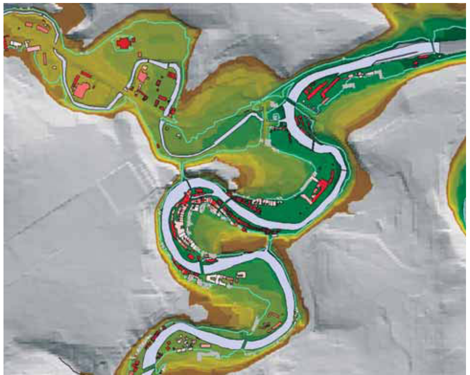
Stanovení výšky zátopy – využití digitálního modelu terénu
