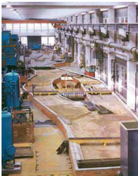
Hydraulický model Prahy (ostrov Štvanice)
