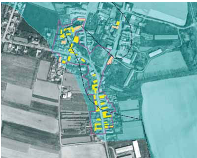
Zálezlice – zaplavené území (žlutě vyznačeny spadlé objekty, oranžově objekty záplavami postižené)
