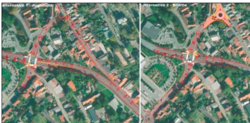
Obr. 3: Příklad návrhu nekonvenční přestavby dvou alternativ průsečné křižovatky v Litomyšli na ulicích Moravská, Mařákova a Kpt. Jaroše (zleva: alt.1 Jughandle, alt.2 Bowtie)
