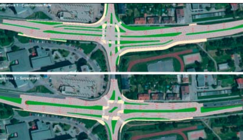
Obr. 1: Příklad návrhu nekonvenční přestavby dvou alternativ průsečné křižovatky v Olomouci na ulicích Velkomoravská a Schweitzerova (shora: alt.1 Continuous Flow, alt.2 Superstreet)
