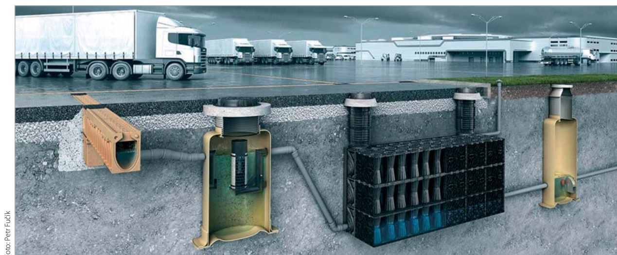
Obr. 1 Schéma moderního odvodnění zpevněných ploch
