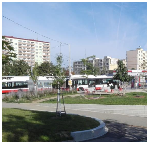
Obr. 44: Sešlapaná zeleň nedostatečně širokého chodníku zastávky MHD a nevhodná koncepce pohybu pěších – chodec, spěchající na zastávku hromadné dopravy, se snaží využít nejkratší možnou cestu, ta vede přes plochu trávníku – Brno, Stará osada.
