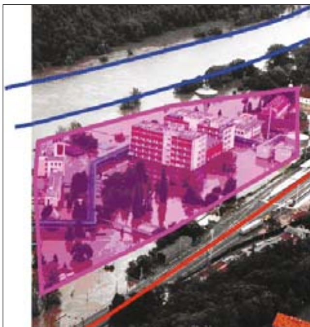
Obr. 4: Roztoky na Vltavě, nevhodná lokalizace průmyslové zóny do průtočného profilu toku
