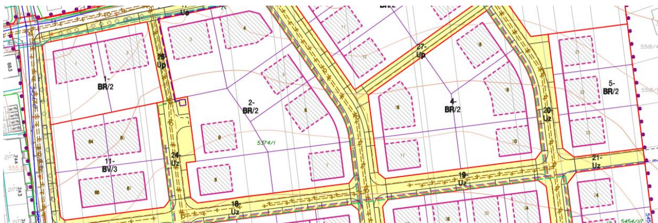
Obr. 4: Výřez z výkresu technické infrastruktury regulačního plánu, který podrobně vymezuje polohu kanalizace, plynovodu i sítě elektro. 11
