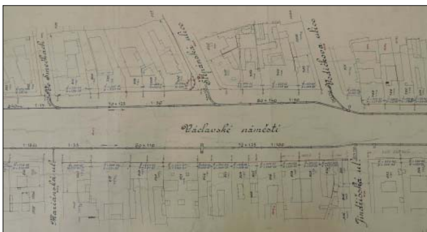
Regulace staveb na Václavském náměstí s určením uliční čáry, výšky římsy a výšky hřebene z roku 1828, detail plánu
