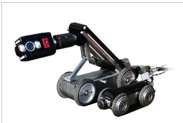
Obr. 42: Příklad kamery pro kamerový průzkum potrubí.
