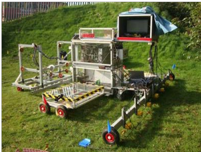
Obr. 45: Funkční prototyp multisenzorového detekčního zařízení, skládajícího se z elektro-magnetických senzorů, georadaru a vibro-akustických senzorů.
