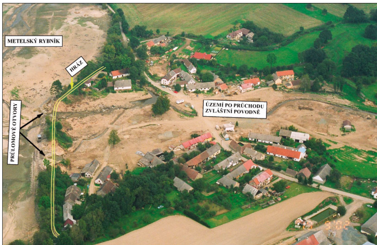
Obr. 1: Obec Metly pod porušeným vodním dílem Metelský rybník (2002) [17] - na obrázku jsou patrné dva průlomové otvory a část obce zničená zvláštní povodní
