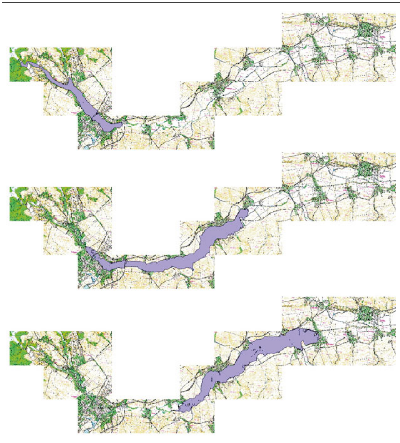
Obr. 8: Postup průlomové vlny v časech 3, 6 a 9 hodin v případě protržení VD Opatovice [12]
