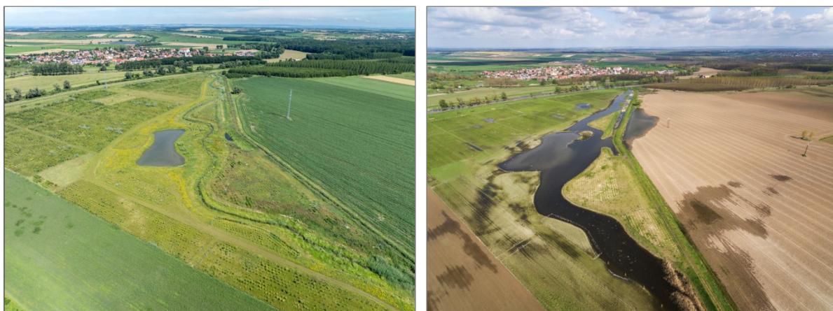
Obr. 55 a 56 Na retenčním prostoru Novosedly je možné ukázat, jak dynamicky se hladina může měnit během roku a tento stav naopak považujeme za žádoucí. Rozliv obdobný druhému snímku můžeme na lokalitě pozorovat po 30 až 60 dnu v každém roce. Při této míře rozlivu lokalita zachytí v krajině veškerou vodu, která do ní přitéká. Foto: Povodí Moravy, s.p., 2025 a 2024.
