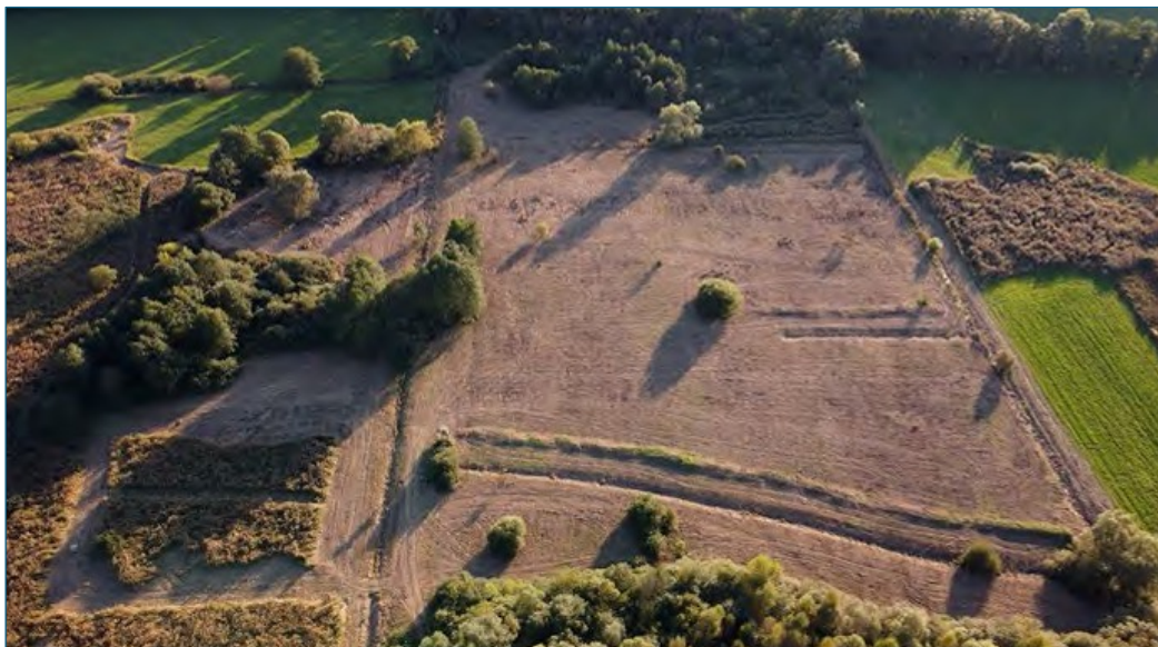
Obr. 51 Letecký snímek z dronu po odstranění vegetace a před zahájením zemních prací. HOZ i další na ně kolmé kanály jsou v ploše dobře viditelné. Foto Michal Sluk, 2021
