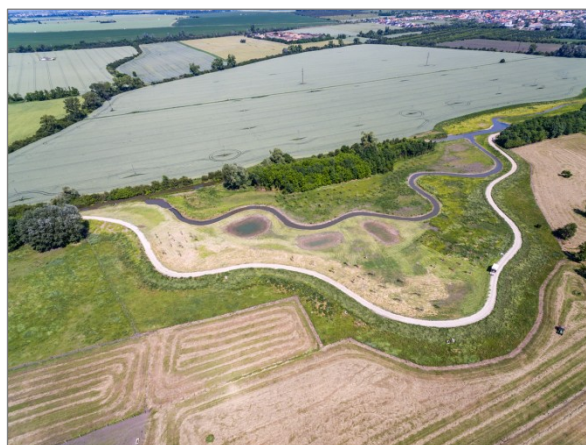
Obr. 45 a 46 Řeka Kyjovka, Moravská Nová Ves. V některých případech může být vedle nového revitalizačního koryta ponecháno i to původní. V takovém případě je vhodné pro revitalizaci vymezit celý prostor mezi oběma koryty, respektive až po případný val nebo hráz, který území revitalizace ohraničuje (druhý snímek). Foto: Povodí Moravy, s.p., 2023.
