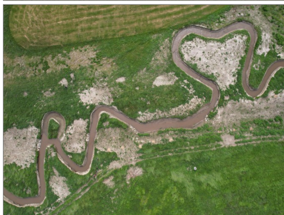
Obr. 47 až 50 Řeka Svatka, Herálec. Přesto, že byla řeka upravena, mnohdy se její původní parcela zachovala v katastru nemovitostí, často stále ve vlastnictví správce toku, případně obce. Revitalizace návratem na původní parcelu je velmi efektivním způsobem revitalizace toku, jak ukazují připojené snímky. Takovéto pozemky musí být chápány jako potenciální součást říční sítě a nemělo by zde být navrženo nakládání, které revitalizaci do budoucna znemožňuje. Foto: Povodí Moravy, s.p., 2022 a 2024. Dostupné: https://www.adapteraawards.cz/databaze/2025/svatka-vcrcena-do-historickeho-koryta-pri-povodni
