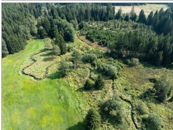
Obr. 47 až 50 Řeka Svatka, Herálec. Přesto, že byla řeka upravena, mnohdy se její původní parcela zachovala v katastru nemovitostí, často stále ve vlastnictví správce toku, případně obce. Revitalizace návratem na původní parcelu je velmi efektivním způsobem revitalizace toku, jak ukazují připojené snímky. Takovéto pozemky musí být chápány jako potenciální součást říční sítě a nemělo by zde být navrženo nakládání, které revitalizaci do budoucna znemožňuje. Foto: Povodí Moravy, s.p., 2022 a 2024. Dostupné: https://www.adapteraawards.cz/databaze/2025/svatka-vcrcena-do-historickeho-koryta-pri-povodni
