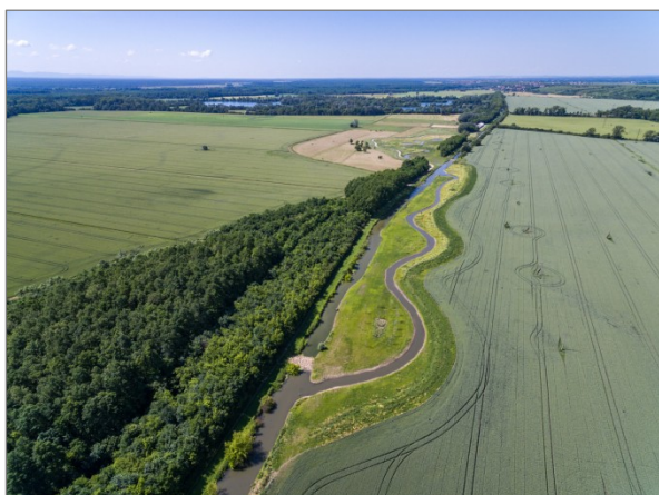
Obr. 45 a 46 Řeka Kyjovka, Moravská Nová Ves. V některých případech může být vedle nového revitalizačního koryta ponecháno i to původní. V takovém případě je vhodné pro revitalizaci vymezit celý prostor mezi oběma koryty, respektive až po případný val nebo hráz, který území revitalizace ohraničuje (druhý snímek). Foto: Povodí Moravy, s.p., 2023.
