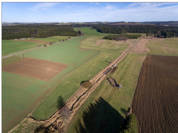
Obr. 45 a 46 Řeka Kyjovka, Moravská Nová Ves. V některých případech může být vedle nového revitalizačního koryta ponecháno i to původní. V takovém případě je vhodné pro revitalizaci vymezit celý prostor mezi oběma koryty, respektive až po případný val nebo hráz, který území revitalizace ohraničuje (druhý snímek). Foto: Povodí Moravy, s.p., 2023.
