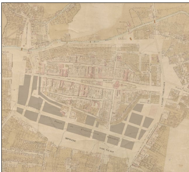
Obr. 5: V roce 1832 vyhotovil inženýr Joseph Ott mapu, do níž zakreslil plánované rozšíření města. Ott uvažoval o přibližně 1 km dlouhé přímé městské třídě a při návrhu uliční sítě vycházel z pravouhého rastru středověkých košických ulic. Vodní tok z příkopu chránícího pevnost svedl do přímého koryta, obdobně jako stromořadí promenády, které tuto logiku následovalo. Tato třída se později stala Rákócziho okružní třídou (dnes Moyzesova ulice)
