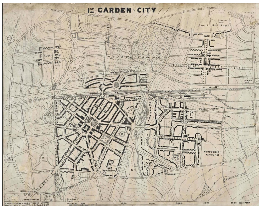
Obr. 2: Plán Letchworth Garden City architektů Parkera a Unwina z roku 1903 (A – hlavní třída, B – nákladové nádraží, C – centrální náměstí, D – veřejná hala, muzeum a další veřejné budovy, E – škola, F – kostel, H – hotel, K – park, L – pošta, M – obecní budova)
