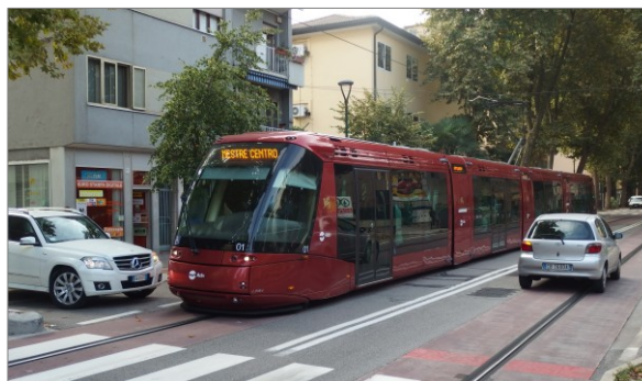
Obr. 49: Tramvaj na pneumatikách se střední kolejnicí, Benátky.
