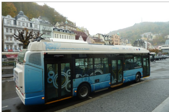
Obr. 3: TriHyBus je český prototyp vodíkového autobusu, který jezdil na lince městské hromadné dopravy v Neratovicích v letech 2009-2014. Hlavním zdrojem elektrické energie byl vodíkový palivový článek, jako palivo sloužil stlačený vodík.
