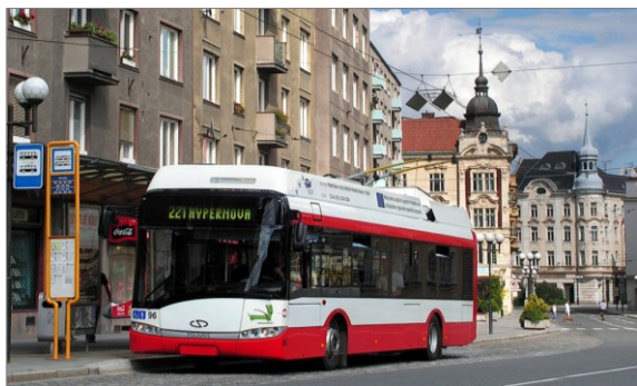
Obr. 48: Duobus (trolejbus s hybridním pohonem), Opava.
