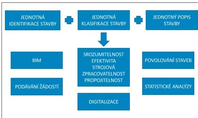
Obr. 5: Klíčové vlastnosti informačního systému identifikačního čísla stavby – jednotná identifikace a klasifikace stavby spolu s jednotným popisem stavby (a zařízení)
