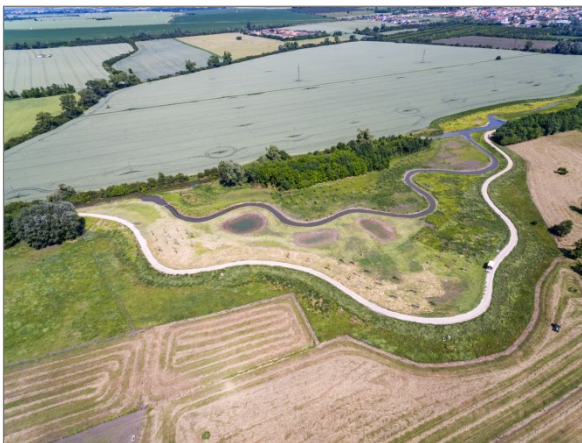
Obr. 45 a 46 Řeka Kyjovka, Moravská Nová Ves. V některých případech může být vedle nového revitalizačního koryta ponecháno i to původní. V takovém případě je vhodné pro revitalizaci vymezit celý prostor mezi oběma koryty, respektive až po případný val nebo hráz, který území revitalizace ohraničuje (druhý snímek). Foto: Povodí Moravy, s.p., 2023.
