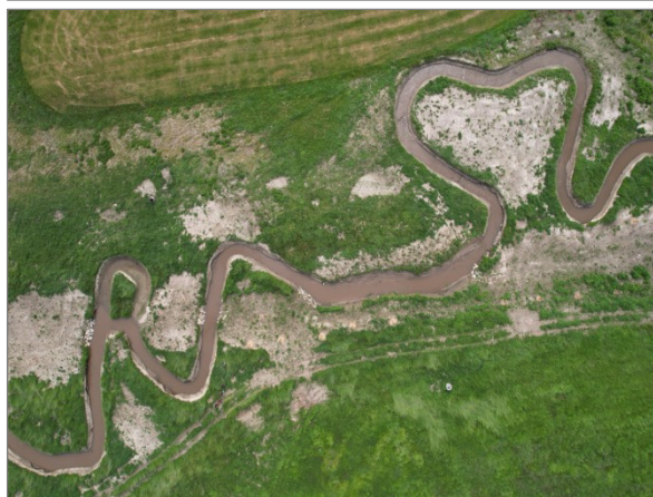
Obr. 47 až 50 Řeka Svatka, Herálec. Přesto, že byla řeka upravena, mnohdy se její původní parcela zachovala v katastru nemovitostí, často stále ve vlastnictví správce toku, případně obce. Revitalizace návratem na původní parcelu je velmi efektivním způsobem revitalizace toku, jak ukazují připojené snímky. Takovéto pozemky musí být chápány jako potenciální součást říční sítě a nemělo by zde být navrženo nakládání, které revitalizaci do budoucna znemožňuje. Foto: Povodí Moravy, s.p., 2022 a 2024. Dostupné: https://www.adaptterraawards.cz/databaze/2025/svatka-vcrcena-do-historickeho-koryta-pri-povodni
