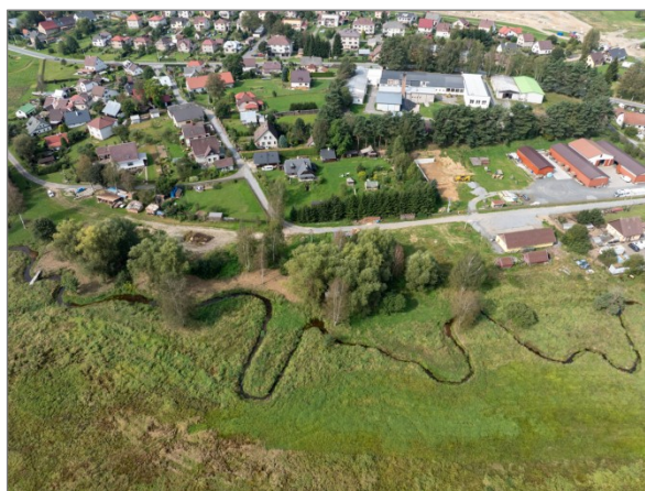
Obr. 45 a 46 Řeka Kyjovka, Moravská Nová Ves. V některých případech může být vedle nového revitalizačního koryta ponecháno i to původní. V takovém případě je vhodné pro revitalizaci vymezit celý prostor mezi oběma koryty, respektive až po případný val nebo hráz, který území revitalizace ohraničuje (druhý snímek). Foto: Povodí Moravy, s.p., 2023.
