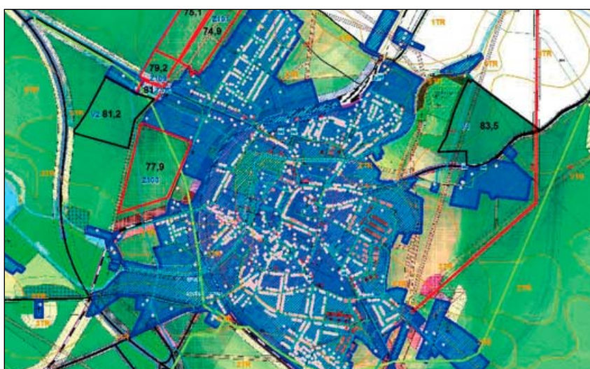
Obr. 6: Návrhové plochy pro průmysl (červeně) a plochy alokované modelem Urban Planner (černě) s hodnotami průměrného potenciálu (bílé body – adresní body, modrá šrafura – zastavěné území, odstíny zelené – územní potenciál)
