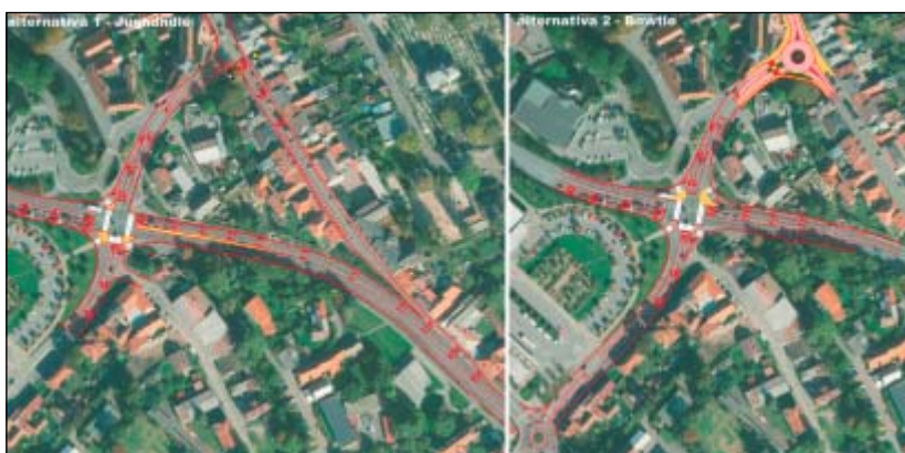
Obr. 3: Příklad návrhu nekonvenční přestavby dvou průsečné křižovatky v Litomyšli na ulicích Moravská, Mařákova a Kpt. Jaroše (zleva: alt.1 Jughandle, alt.2 Bowtie)
