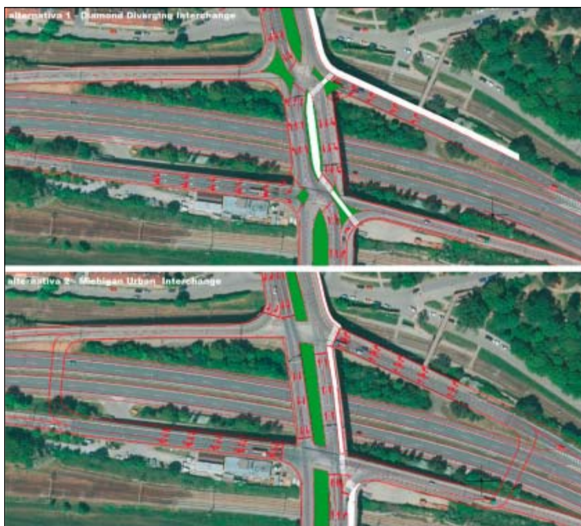
Obr. 4: Příklad návrhu nekonvenční přestavby dvou alternativ průsečné křižovatky v Brně na ulicích Ostravská, Černovická a Otakara Ševčíka (shora: alt.1 Diamond Diverging Interchange, alt.2 Michigan Urban Interchange)
