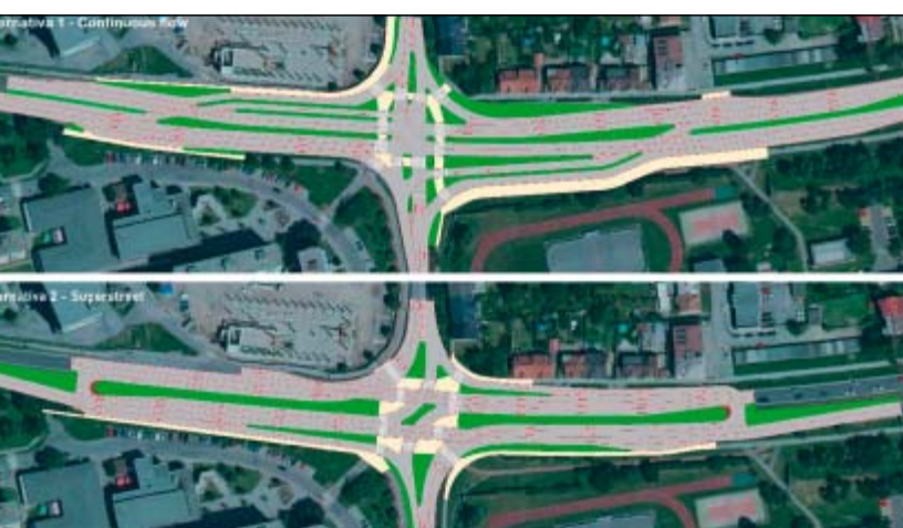
Obr. 1: Příklad návrhu nekonvenční přestavby dvou průsečné křižovatky v Olomouci na ulicích Velkomoravská a Schweitzerova (shora: alt.1 Continuous Flow, alt.2 Superstreet)
