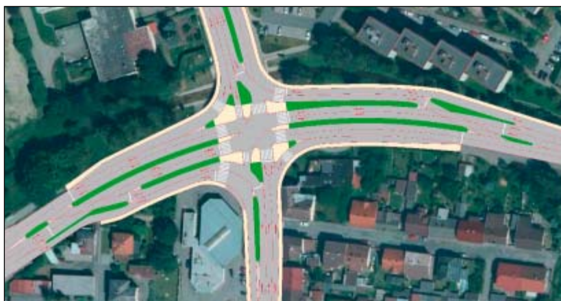
Obr. 2: Příklad návrhu nekonvenční přestavby Parallel Flow na průsečné křižovatce v Havlíčkově Brodě na ulicích Masarykova, Humpolecká, Lidická a Dolní
