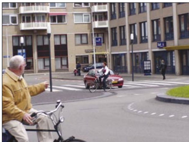
Obr. 1 (vlevo): Nizozemské město Drachten (rok 2005). Původně světelně řízená křižovatka přestavěná na křižovatku okružní, žádné svislé dopravní značení, plochy ve stejné výškové úrovni.
